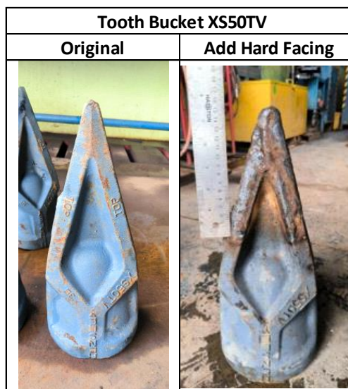
Gambar 1. Tooth Bucket Genuine dan Setelah Hard Facing
